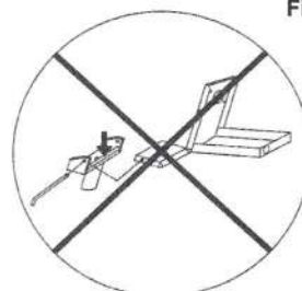
POSIZIONE ERRATA MONTAGGIO PIASTRA MOTORE
