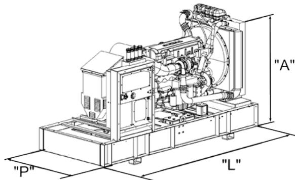
Per le **dimensioni di ingombro** riferirsi ai dati indicati nel disegno tecnico di installazione fornito a corredo.
