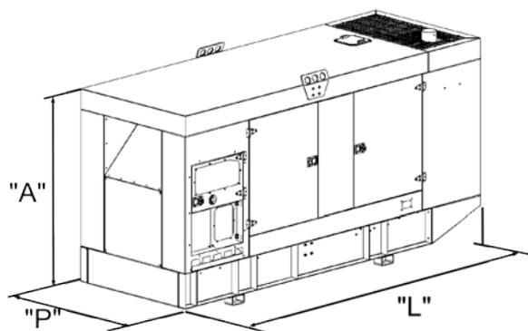
Per le **dimensioni di ingombro** riferirsi ai dati indicati nel disegno tecnico di installazione fornito a corredo.
