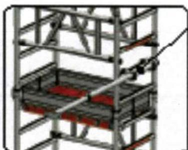
**1. Barra di ancoraggio orizzontale (regolabile telescopica)**
